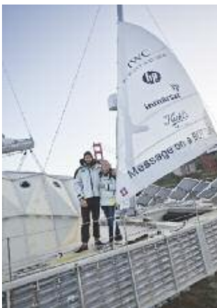
Über 12000 PET-Flaschen sorgen für den Auftrieb der «Plastiki».
