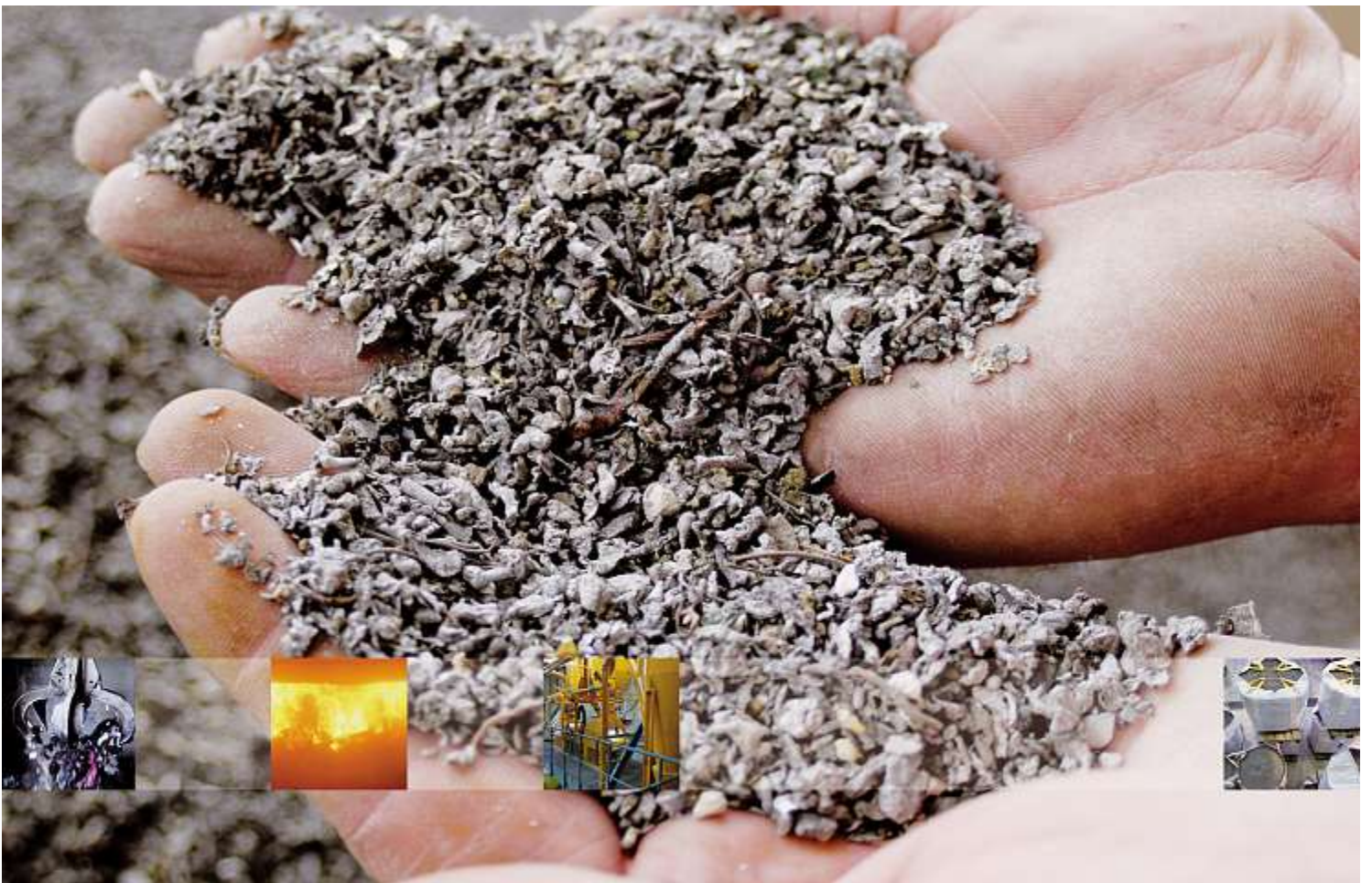
Mit einfachen Trennprozessen werden aus der Schlacke wertvolle Metalle wie Kupfer, Gold, Silber und Palladium gewonnen. – Fotos: ©ZAR
