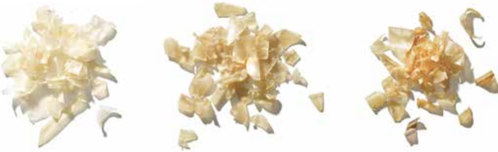
Das Ergebnis vom Einsatz von Barrieren und Additiven: Flakes von hellgelb bis dunkelbraun.
